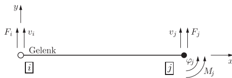
Bild A.24. Freiheitsgrade und Belastungen des Balkens mit Gelenk
