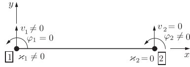
Bild A.29. Zweiknotiges Element mit den dazugehörigen Freiheitsgraden und Randbedingungen
