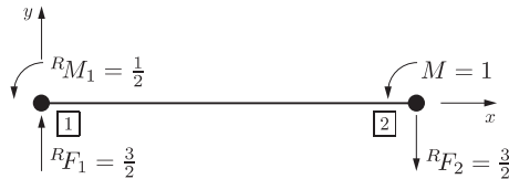
Bild A.20. Auflagerreaktionen des Balkens
